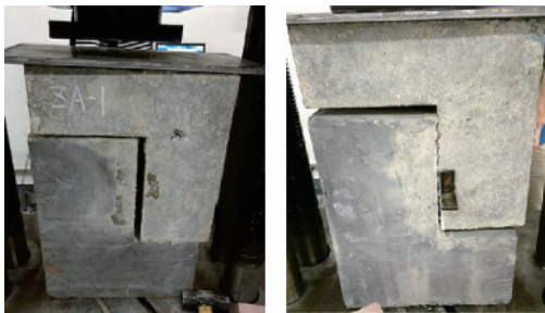
图5 Z型试件裂缝
